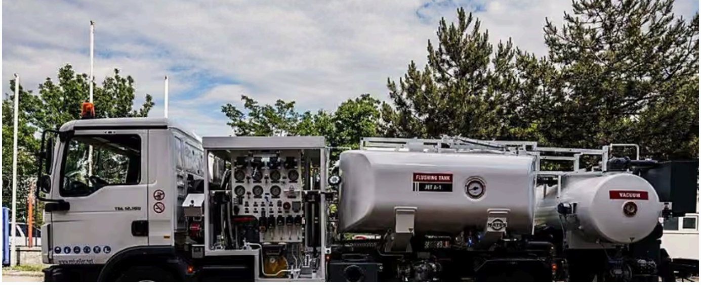
Şekil 1 · MATEŞ hidrant pit temizleme aracı, ekipman dolabı açık, yan profil. Renk düzeni ve donanım siparişe göre değişir.
